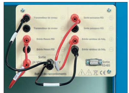
Bornier regroupant les entrées et sorties des capteurs PID et commande variateur
